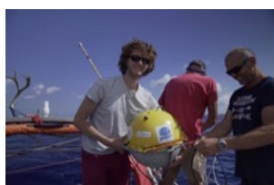
Hypatia , à rincer après utilisation pour que le sel n'abîme pas les capteurs. DR
