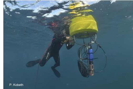
Bouée mise en place à Taiaro avec instruments de mesure du niveau de l'eau et de salinité.
